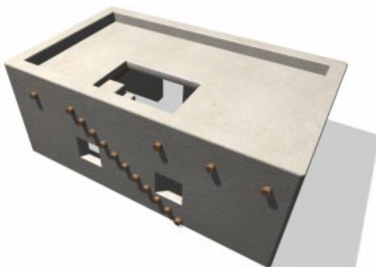
■ Figura 12.13 Retro della casa con i tronchi che reggono gli scalini sporgenti fuori dalle mura.
